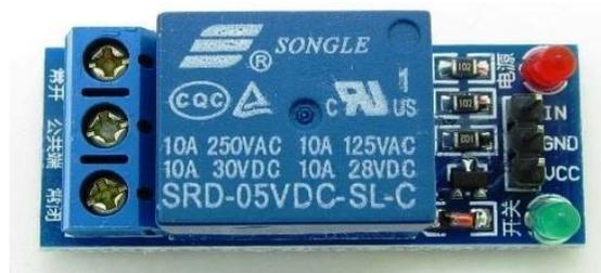
Fig.2. Relay Module
