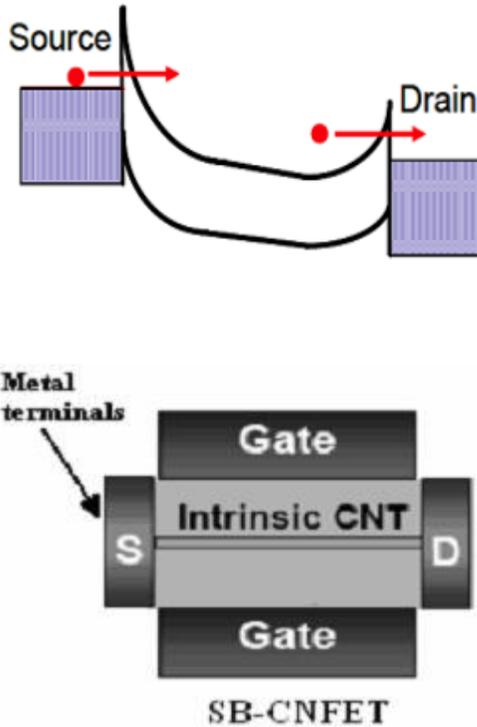
Fig.5. Schottky-Barrier CNTFET (SB-CNFET)
