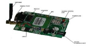
Fig.1. GSM Modem
